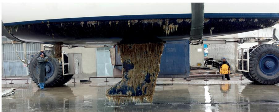
Fig. 9 Chiglia, deriva e bulbo di barca a vela da diporto infestati da ascidie dopo 18 mesi di permanenza in acqua in Adriatico settentrionale (Foto di M. Ponti).
